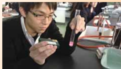
レーザーポインターを使って、コロイド溶液の性質を確認しています。
